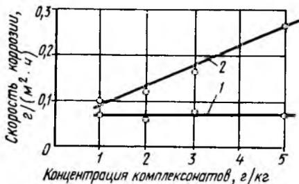
Рис. 17.9. Скорость коррозии латуни Л68 в зависимости от содержания комплексонатов меди (1) и железа (2) в растворе трилона Б с лимонной кислотой при рН=4, циркуляции раствора и температуре 80—85 °С, без ингибитора
